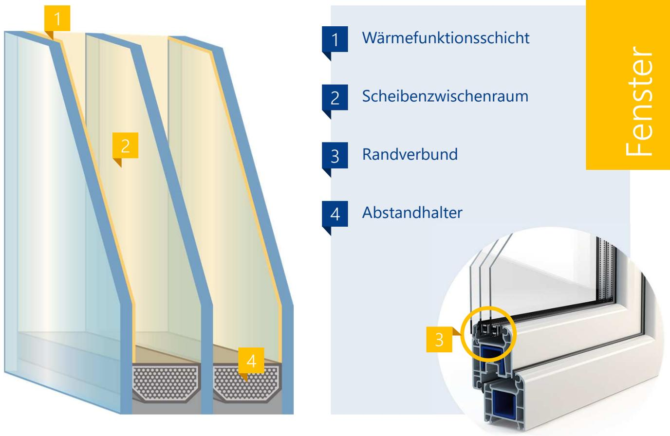
Die **Wärmefunktionsschicht** ist die Beschichtung des Fensterglases mit einer dünnen Metallschicht. Sie verbessert den Wärmeschutz der gesamten Verglasung.
