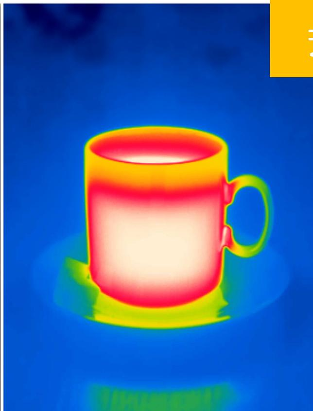
Dank bekannter physikalischer Gesetzmäßigkeiten und Zusammenhänge kann aus der erfassten Wärmestrahlung auf die Temperaturverteilung an der Oberfläche des betrachteten Gegenstandes geschlossen werden. Durch die Flächendarstellung der Temperaturverteilung ermöglicht die Bau thermografie energetische Schwachstellen und Wärmebrücken, d. h. Bereiche der Gebäudehülle mit erhöhten Wärmeverlusten und Undichtigkeiten, festzustellen.
